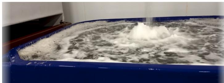
L'**eau**, pour ces bacs et pour la cuve, circule en **circuit fermé** et est **filtrée** par un appareil situé à l'extérieur.
